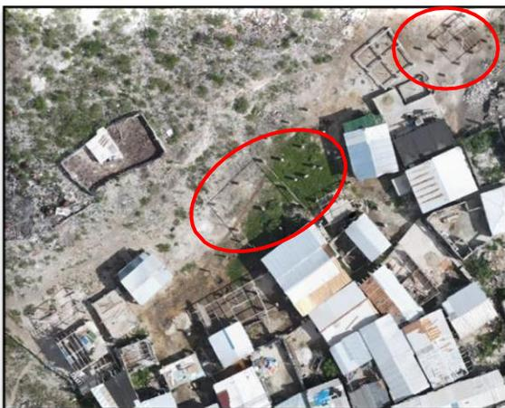
El límite norte de Dock Yard está marcado por una cuenca hidrográfica. Las estructuras de esta zona se han construido sobre pilotes para evitar la subida del nivel del agua. Ver la **Figura 2 – Fundaciones de Pilotes de Dock Yard**.
